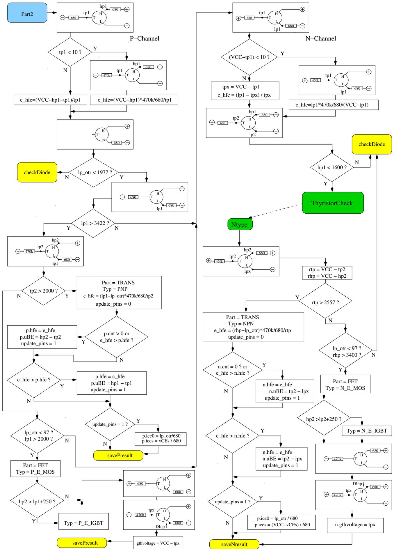
Abbildung 5.9. Ablaufplan der Transistorprüfung Teil 2, BJT und E-MOS
