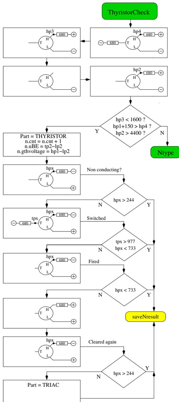
Abbildung 5.10. Ablaufplan der Transistorprüfung Teil 3, Thyristor und Triac
