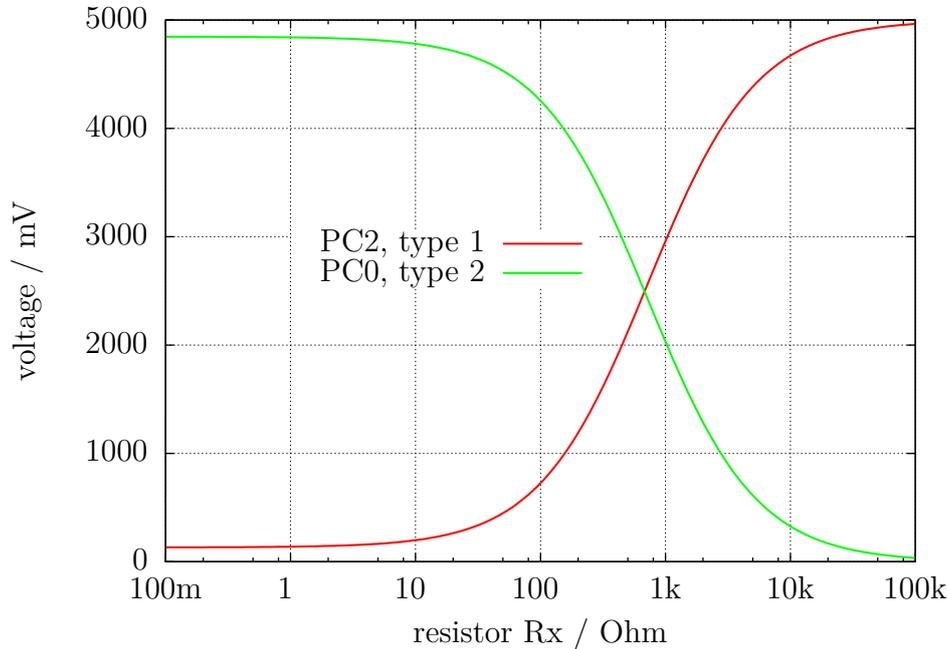
Abbildung 5.13. Spannung von Type 1 und Type 2 mit Messwiderstand  $680\Omega$
