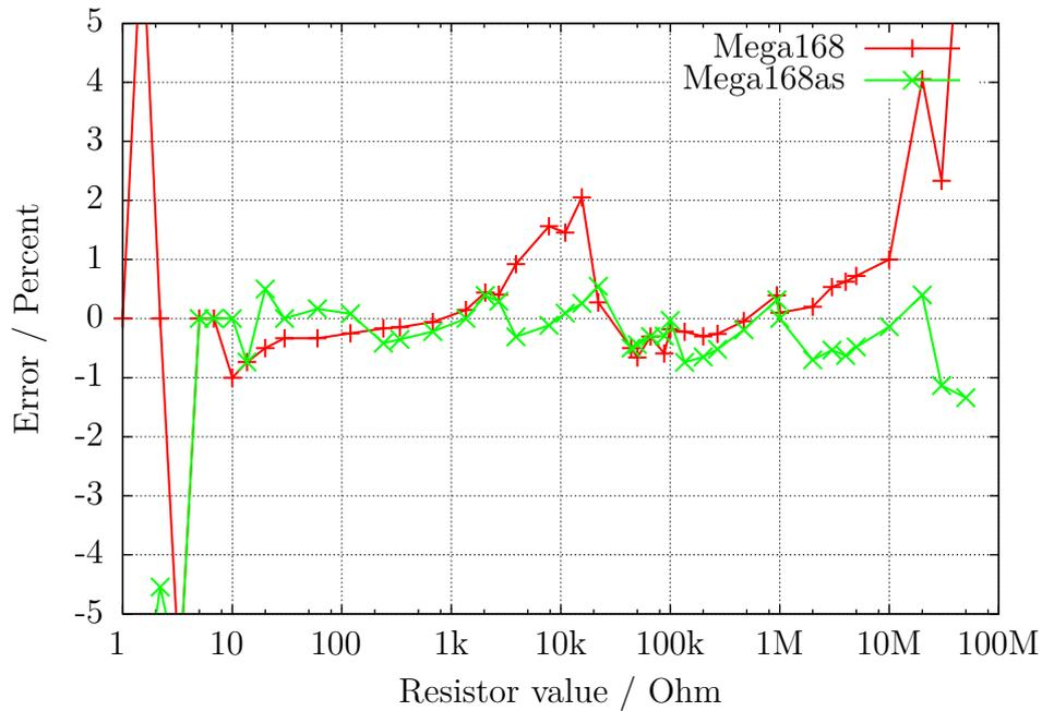
Abbildung 5.20. Relativer Fehler für Widerstand-Messungen mit ATmega168
