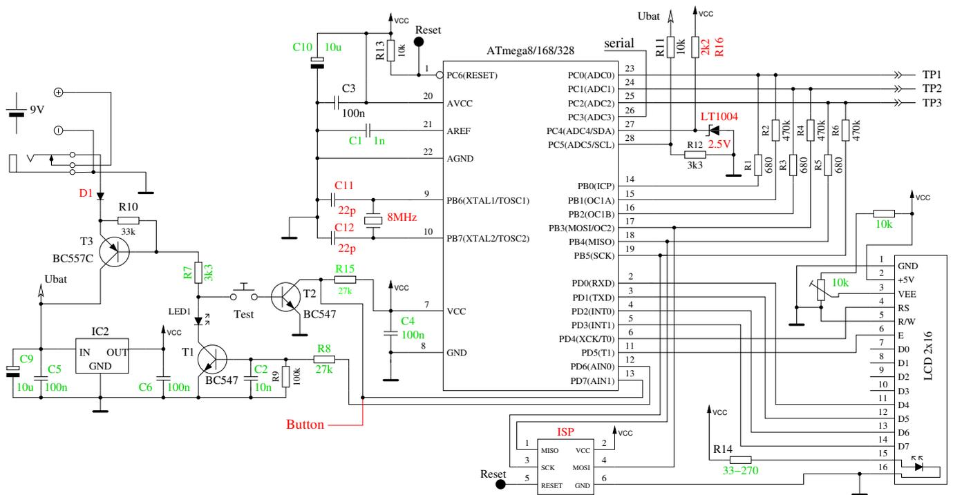
Abbildung 2.1. Neue Transistor-Tester-Schaltung
