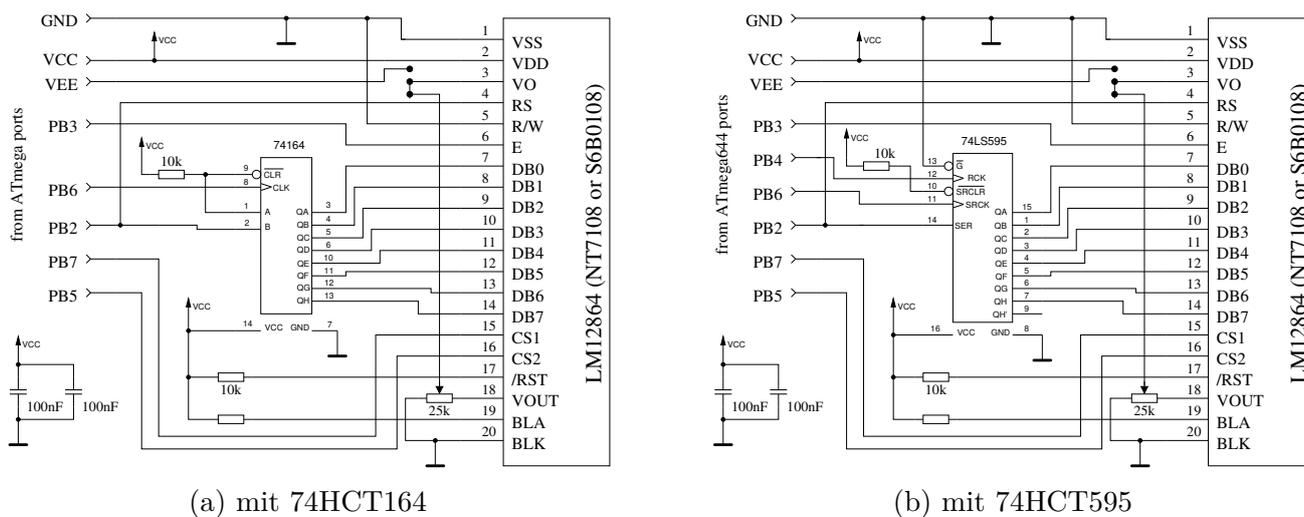
Abbildung 2.25. Anschluss des NT7108 Controllers an einen ATmega644/1284
