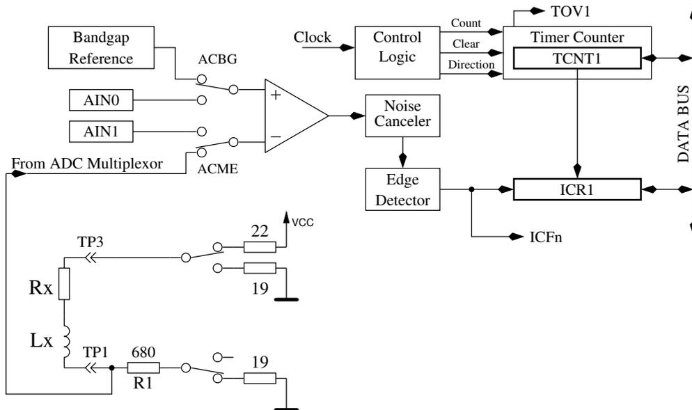
Abbildung 5.62. Messung von Induktivitäten mit dem Komparator
