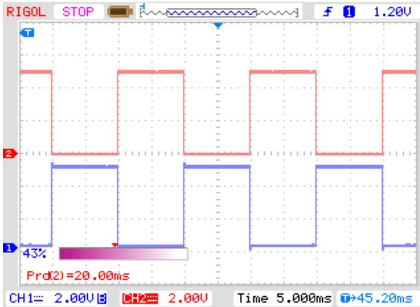
Abbildung 5.68. Oszillogramm der 50Hz Ausgänge von Port 2 und 3
