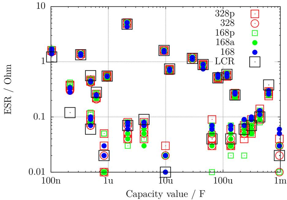
Abbildung 5.44. Messergebnisse der ESR-Messungen mit 15 verschiedenen ATmega, Methode 2
