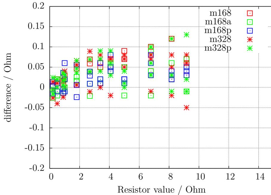
Abbildung 5.46. Messfehler von Widerständen mit der ESR Messung
