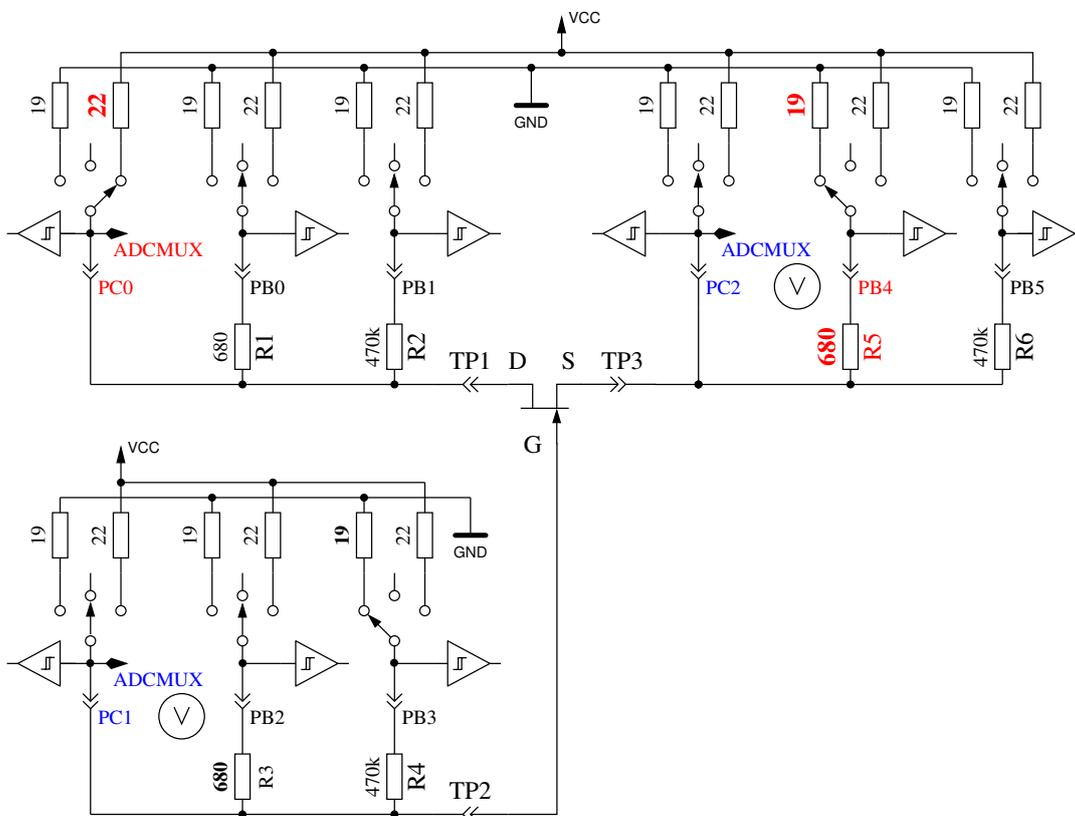
Abbildung 5.3. Messung von Gate-Source-Spannung und Source-Strom eines N-JFET-Transistors
