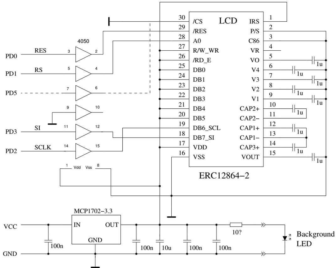
Abbildung 2.9. Anschluss eines graphischen Displays mit ST7565 Controller
