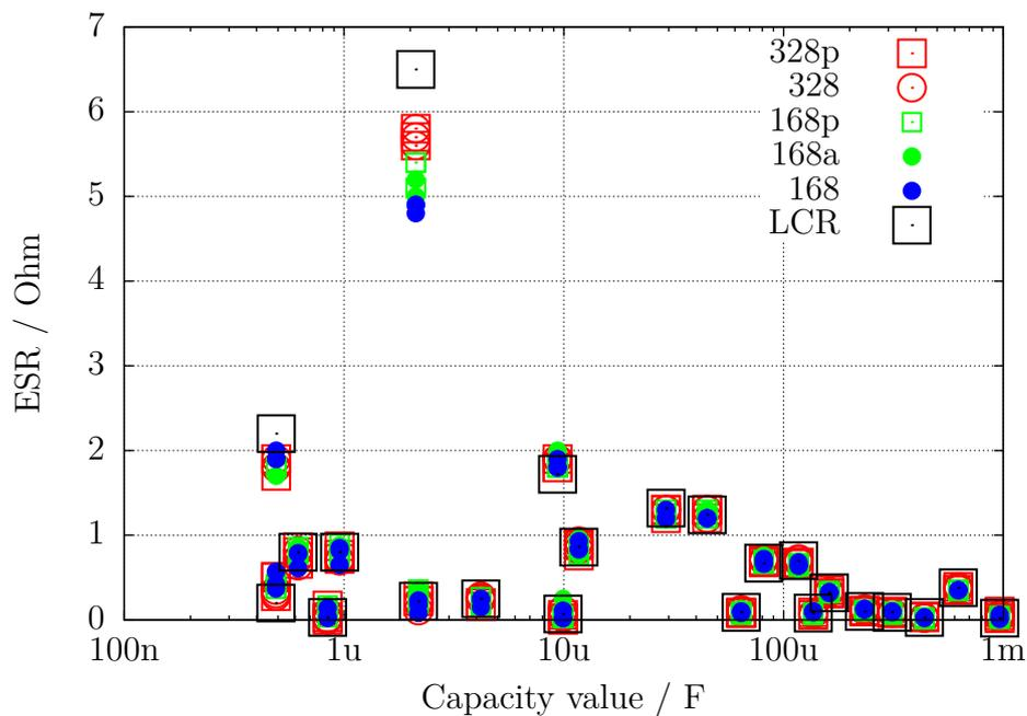
Abbildung 5.38. Messergebnisse der ESR-Messungen mit 15 verschiedenen ATmega
