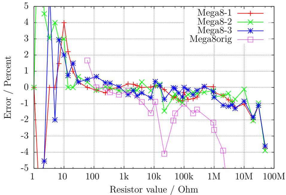
Abbildung 5.18. Relativer Fehler für Widerstands-Messungen mit ATmega8
