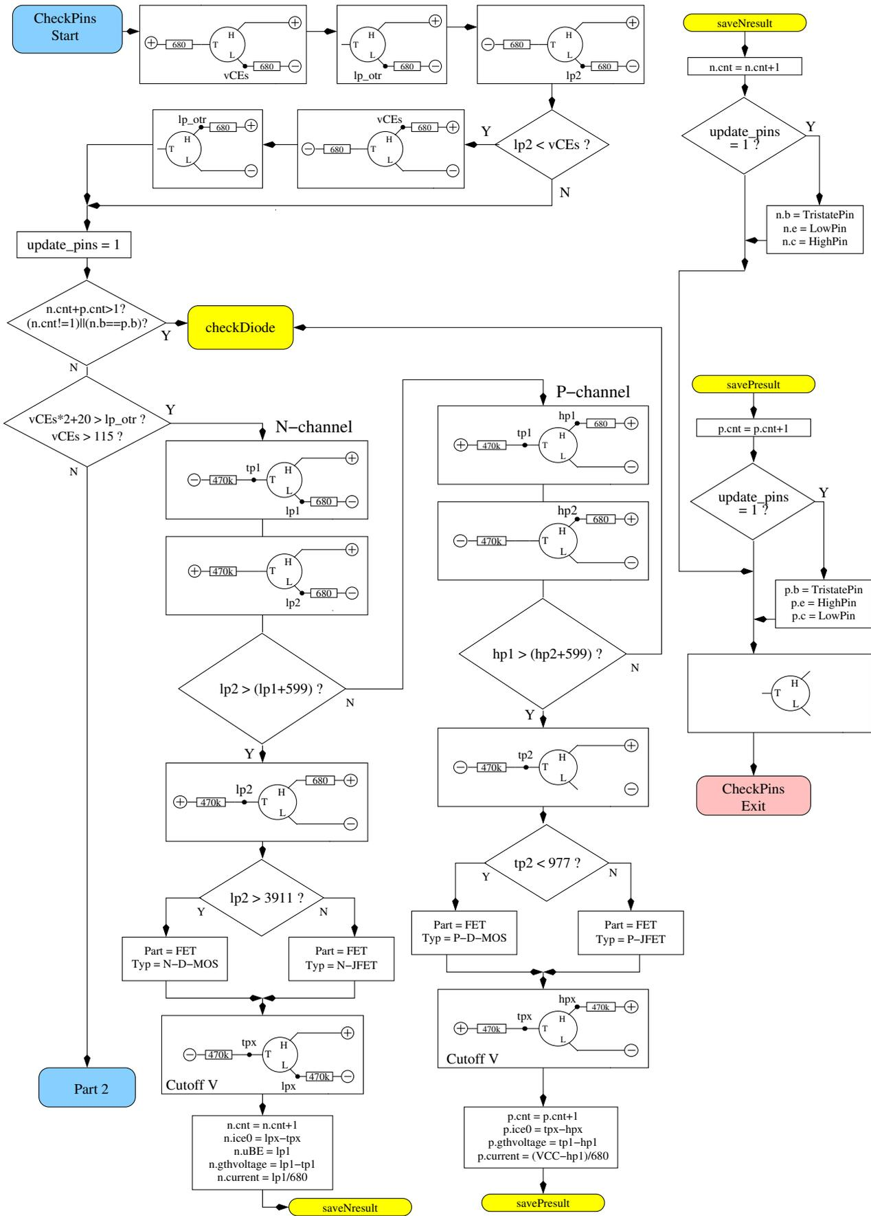
Abbildung 5.8. Ablaufplan der Transistorprüfung Teil 1, JFET und D-MOS
