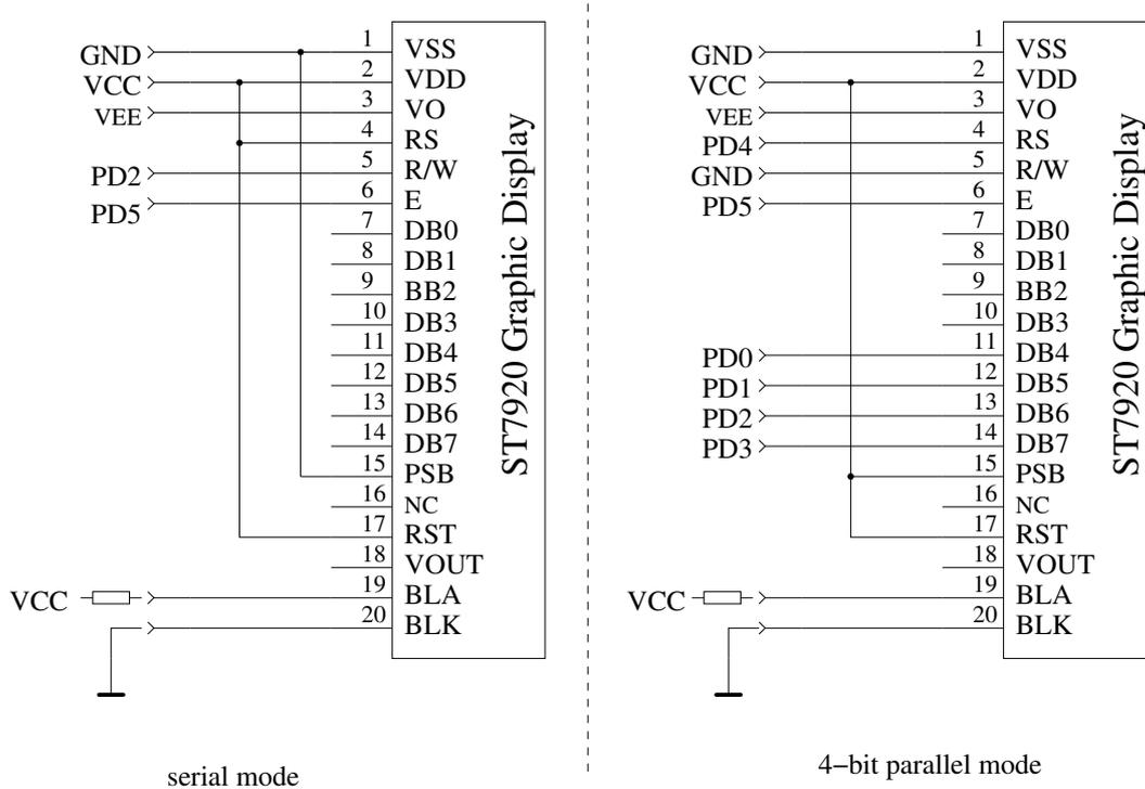
Abbildung 2.11. Anschluss eines Displays mit ST7920 Controller
