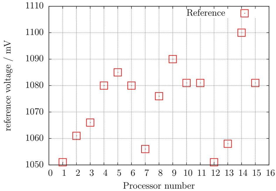
Abbildung 5.69. Selbsttest: Referenz-Spannungen
