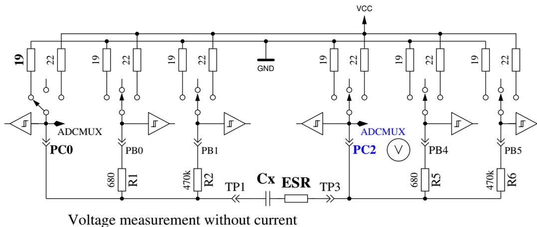
Abbildung 5.35. Schaltbild der ESR-Messung eines Kondensators
