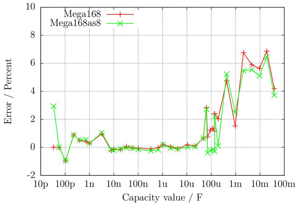
Abbildung 5.50. Prozentualer Fehler der Kondensator-Messungen mit dem ATmega168
