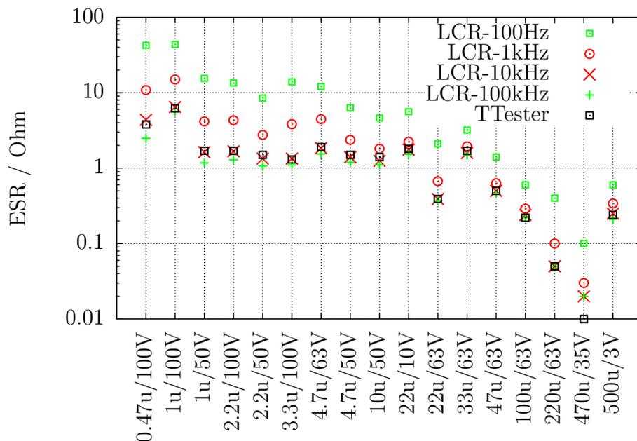
Abbildung 5.45. Ergebnisse der ESR-Messungen von verschiedenen Elektrolyt-Kondensatoren
