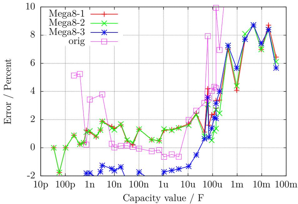
Abbildung 5.48. Prozentualer Fehler der Kondensator-Messungen mit drei ATmega8
