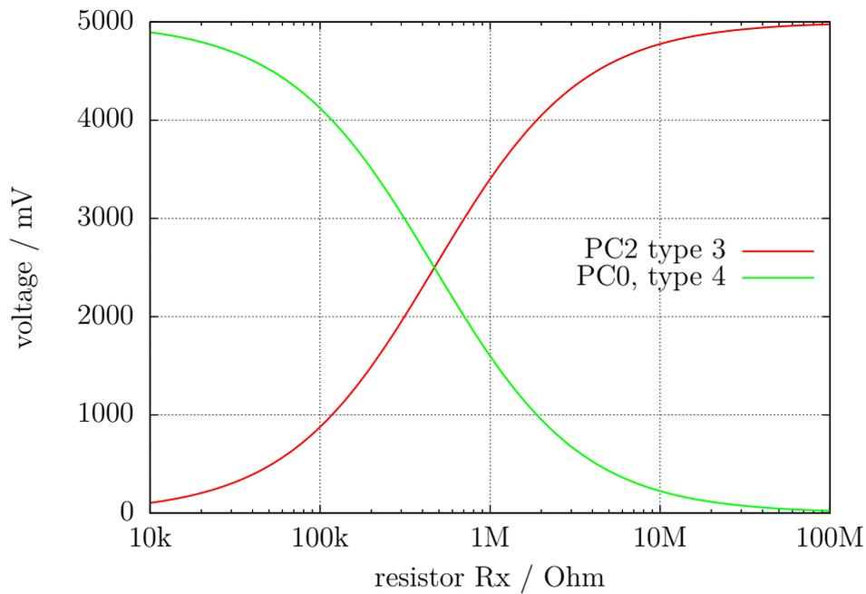
Abbildung 5.17. Spannungen bei Messungen von Type 3 und Type 4 mit  $470k\Omega$
