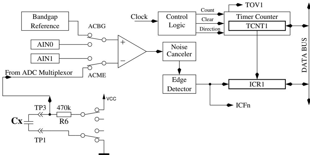
Abbildung 5.28. Messung kleiner Kapazitätswerte mit dem Komparator
