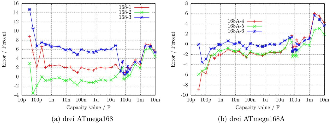
Abbildung 5.52. Kondensator-Messfehler, unkalibriert
