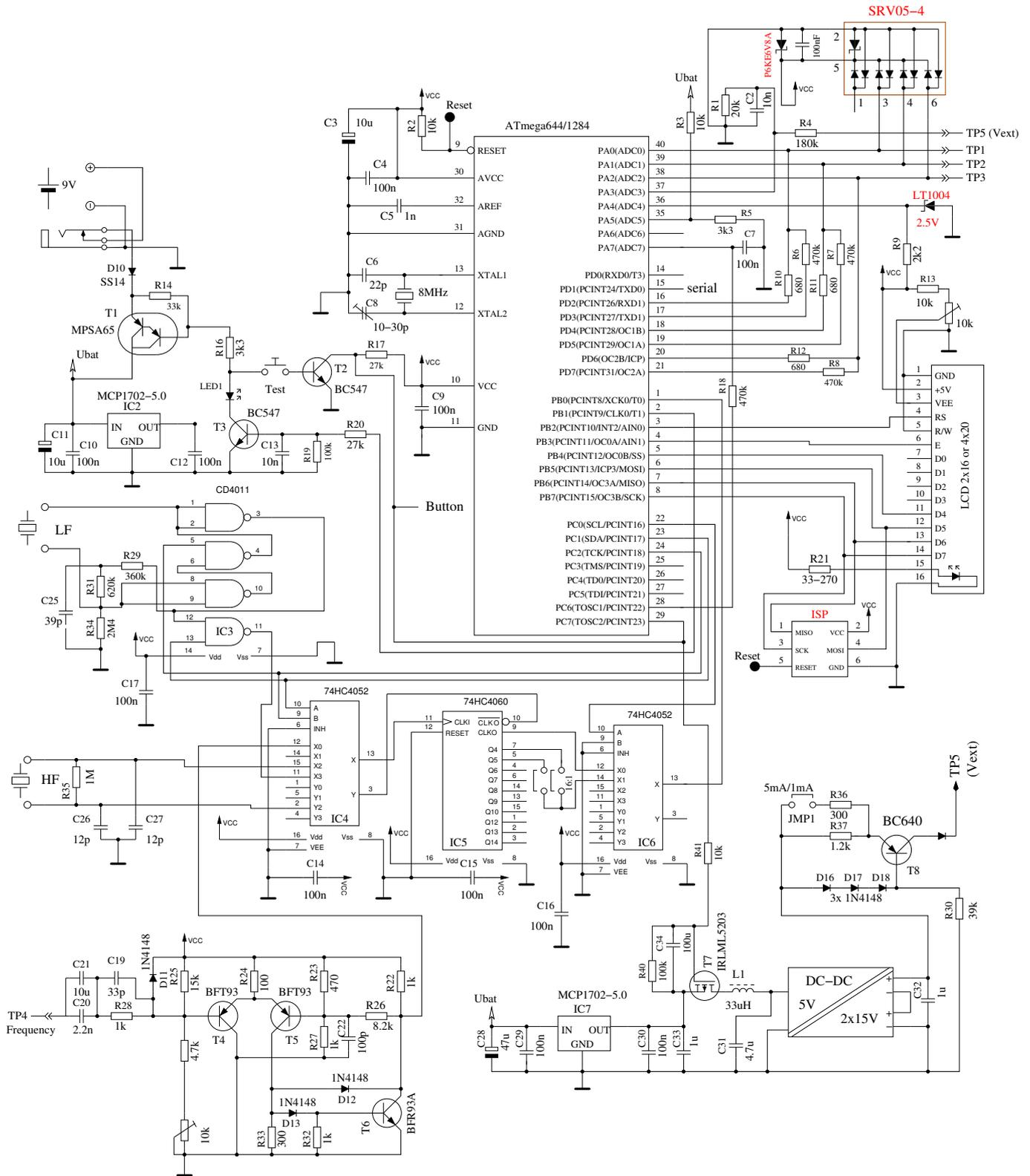
Abbildung 2.26. Erweiterte Transistortester Schaltung mit ATmega644
