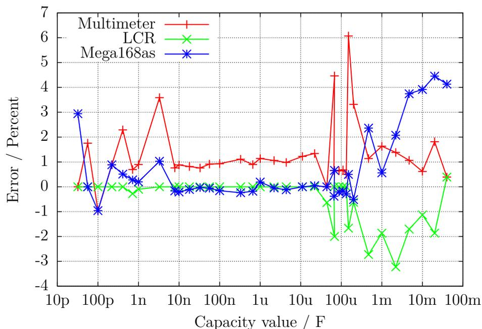
Abbildung 5.51. Vergleich der Kondensator-Messungen mit Multimeter, LCR-Meter und ATmega168
