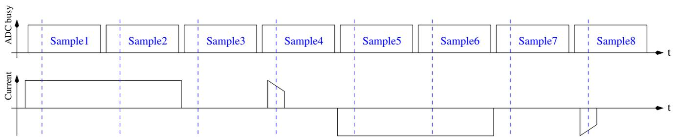
Abbildung 5.39. Zeitlicher Ablauf eines Messzyklus der neuen ESR-Messung
