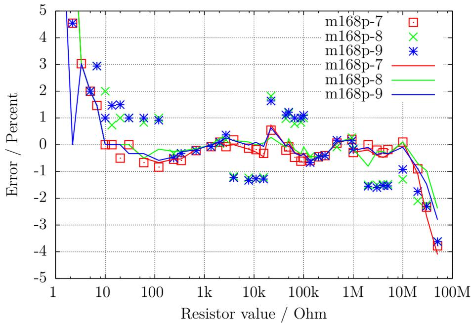
Abbildung 5.22. Relativer Fehler für Widerstands-Messungen mit drei ATmega168P
