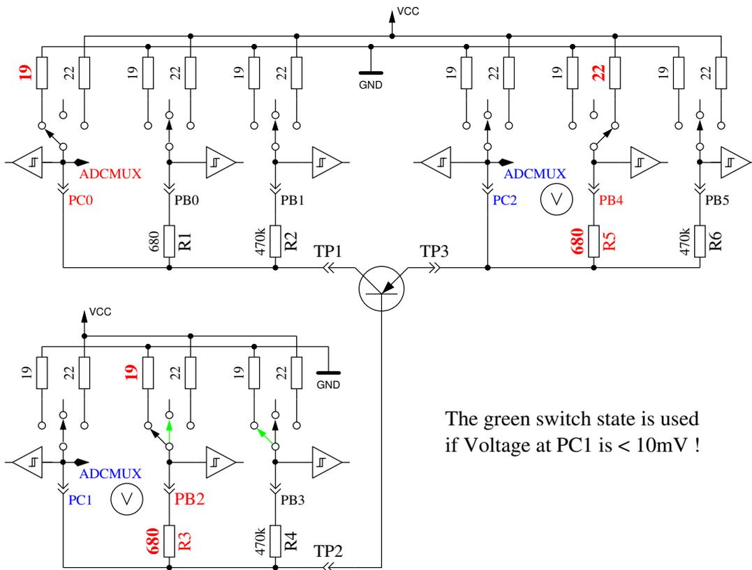
Abbildung 5.4.  $hFE$ -Messung eines PNP-Transistors in Kollektor-Schaltung
