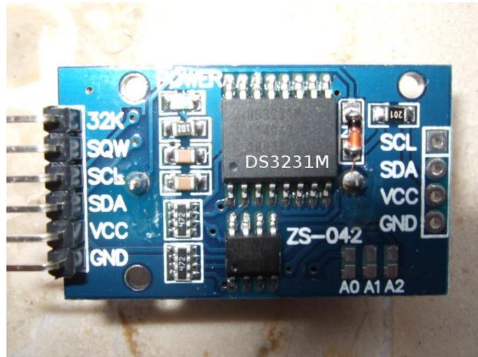
Abbildung 5.78. Ein Exemplar der untersuchten DS3231 Module
