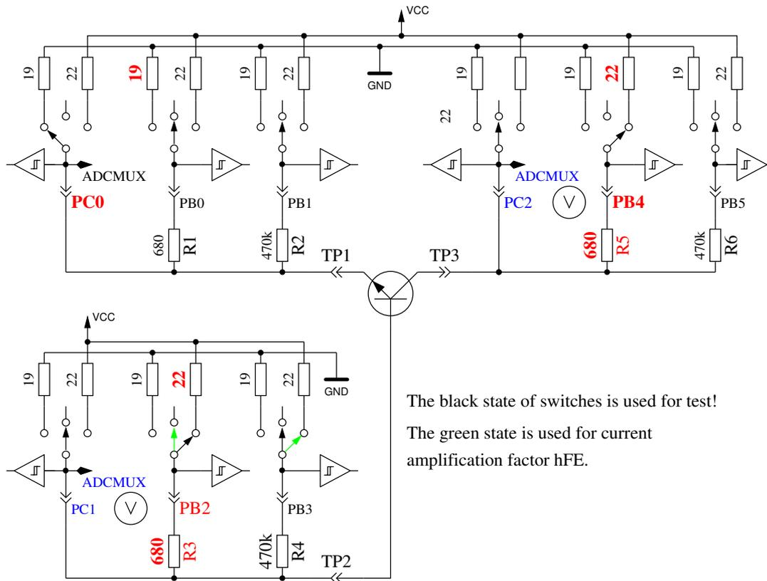
Abbildung 5.6. Prüfung und hFE-Messung eines NPN-Transistors in Emitter-Schaltung
