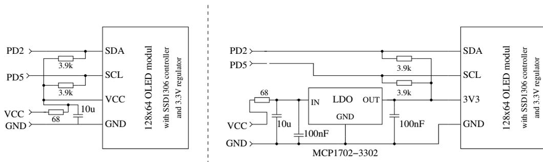
Abbildung 2.10. Anschluss eines graphischen OLED Displays mit I<sup>2</sup>C Schnittstelle
