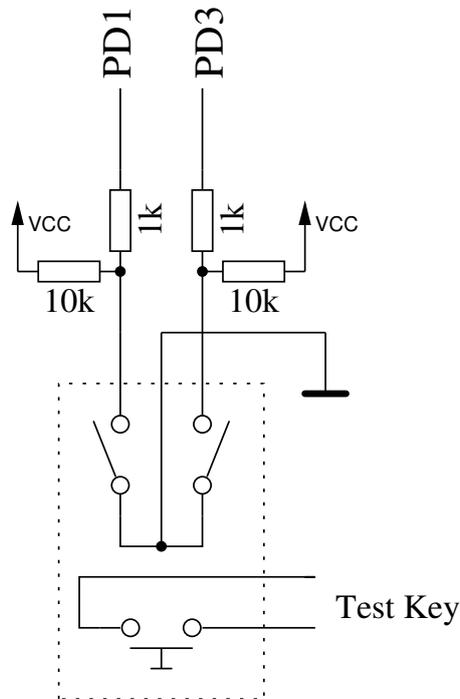
Abbildung 2.6. Erweiterung um einen Impulsdrehgeber
